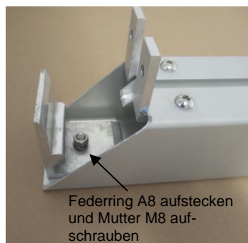
Schraube von der Außenseite des Holms durchstecken
